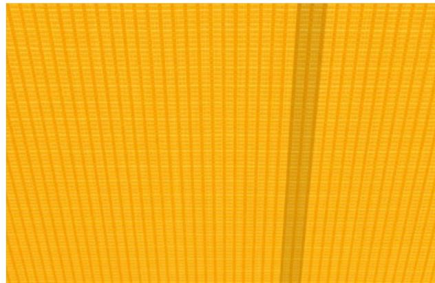
**Geklebte Markisentücher** Mit Ultraschall verschweißte Bahnenverbindungen sorgen für ein homogenes Erscheinungsbild. Die hervorragende Wasser-, Licht- und Temperaturbeständigkeit verlängert die Lebensdauer des Tuches.
